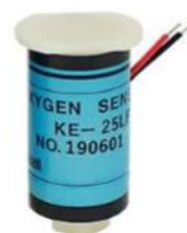
რის. 7. Внешний вид датчика кислорода KE-25LF
