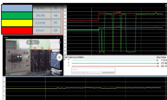
ნახ. 2. SCADA სისტემის სამომხმარებლო ინტერფეისი
