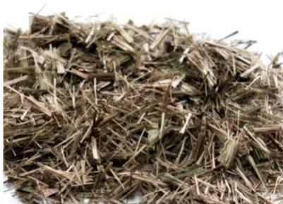
Fig. 7. Basalt fiber
